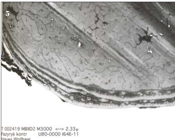
Elektronenmikroskopischer Querschnitt eines blaufärbten Wollhaares aus dem Pazyryk-Teppich, Vg x 3000. Foto: Karl Meßlinger, Universität Erlangen
