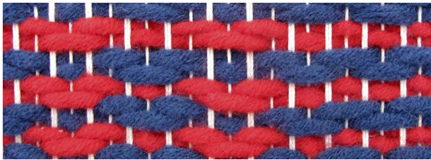
25a Nachwebung, Struktur geöffnet, Seite A Farbwechsel des Garns nach jedem 2. Schuss
