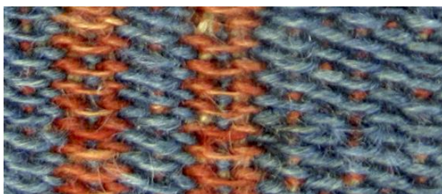
22a+b OS – Details, bei denen der Warenwechsel sowie die Anbindepunkte gut sichtbar sind
